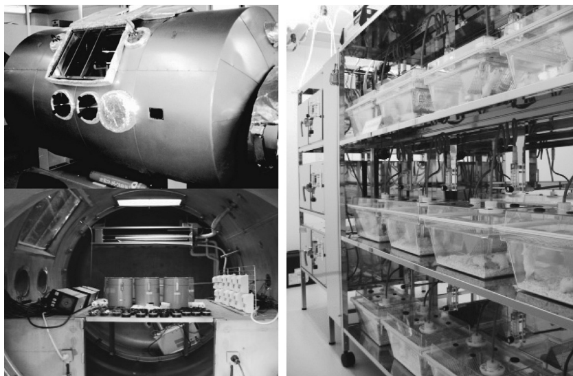
図 2 ラドン標準校正チェンバ (左) とラドン吸入試験設備 (右)
